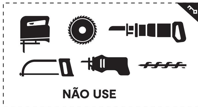
Os fabricantes de ferramentas desenvolveram tipos específicos de lâminas e brocas para a fabricação de produtos de superfície sólida. Lâminas de escarificação tradicionais ou combinadas usando um chanfro superior alternativo a moagem causará cortes ásperos e lascas. Sempre use lâminas de “chip triplo” ou estilos semelhantes que sejam especificamente projetado para uso em materiais de superfície sólida.
